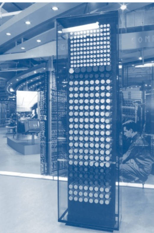
Bauteil der ENIAC, des ersten funktionsfähigen Röhrenrechners der Welt im Heinz Nixdorf MuseumsForum (HNF), Paderborn
